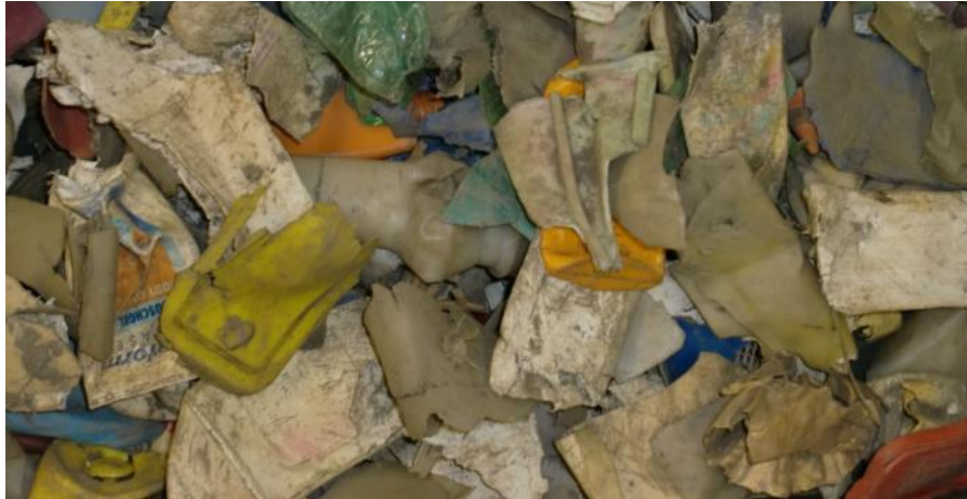
Abbildung 5-7: 3D-Kunststoffe aus rückgebautem Deponiematerial 24
