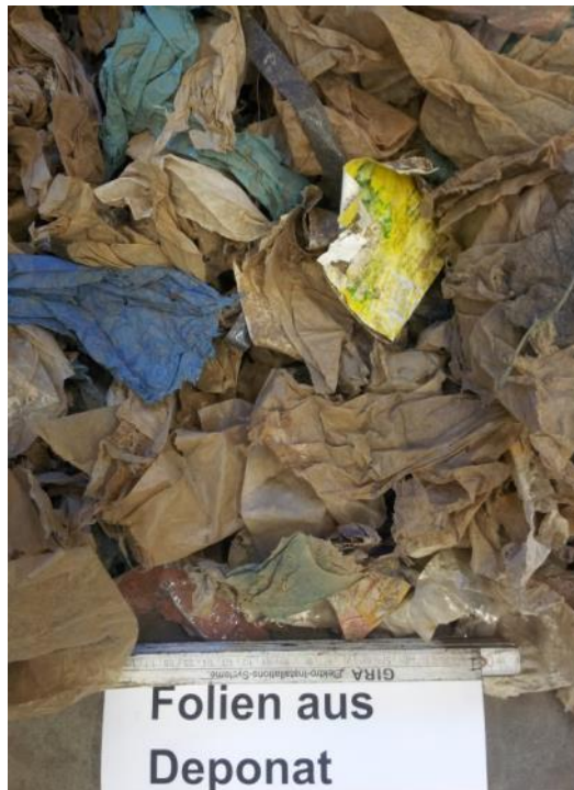
Abbildung 5-8: Abgetrennte Folien aus rückgebautem Deponiematerial
