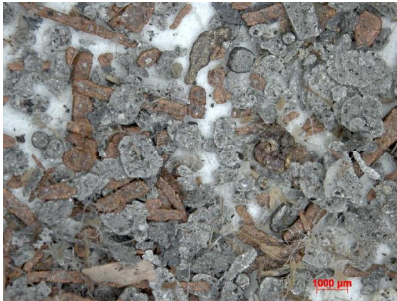
Abbildung 5-6: Kupfer-Aluminium-Mischkonzentrat der Feinkornaufbereitung
