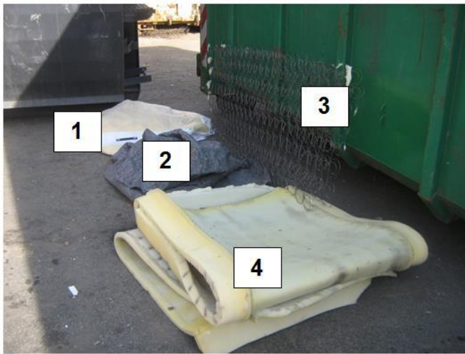
Bild 55: Matratzenkonstruktionsmaterialien nach Matratzenzerlegung
