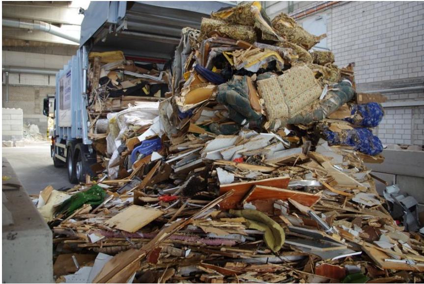
Bild 16: Anlieferung mit Pressmüllfahrzeug
