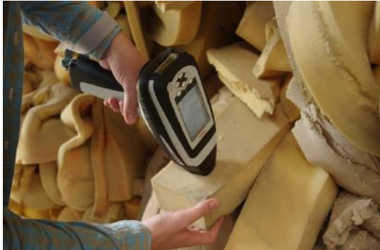
Bild 57: Kunststofferkennung mittels Handmessgerät.
