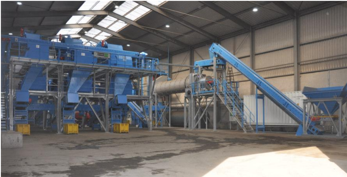
Abb. 6: Teilansicht der STRATEGO-Anlage zur Rückgewinnung von Metallen aus MVA-Schlacken (Foto: CC Umwelt)
