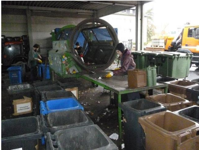
Abbildung 11: Sortierung mittels Trommelsiebmaschine
