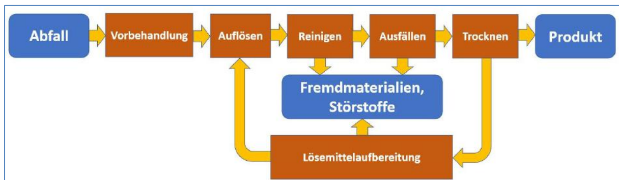
Abbildung 10: Verfahrensschema des lösemittelbasierten Recyclings
