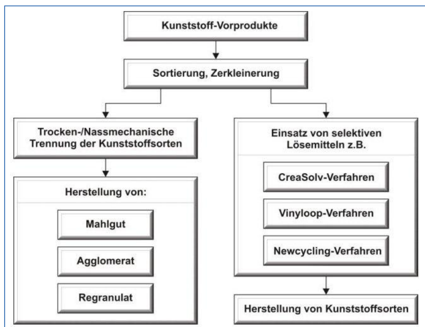
Abbildung 7: Verfahren der werkstofflichen Verwertung von Kunststoffen 16
