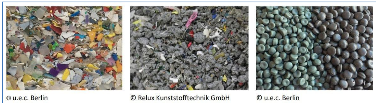
Abbildung 9: Aufarbeitungsprodukte des mechanischen Recyclings (links: Mahlgut; Mitte: Agglomerat; rechts: Regranulat) 19
