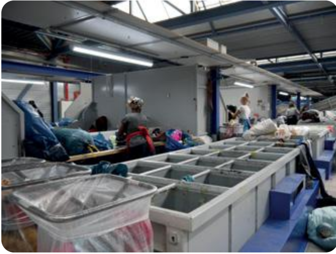
Foto 4: Sortiertisch zur Erstsartierung in einer Sortieranlage in den Niederlanden (2022)
