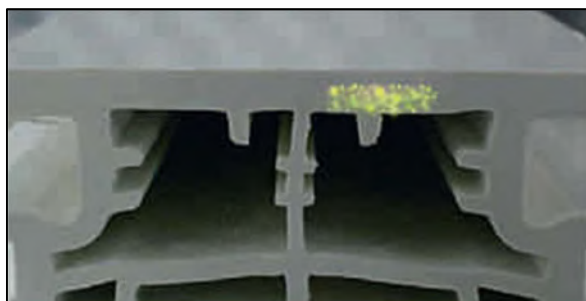
Abbildung 17 Ein glasfaserverstärktes PVC-Fensterprofil dessen Profil-Kern angeregt wird (Fluoreszenz in der Bildmitte). Die unmarkierte Fensteraußenschicht leuchtet nicht. Quelle: Woidasky et al. 2020b, S. 445.
