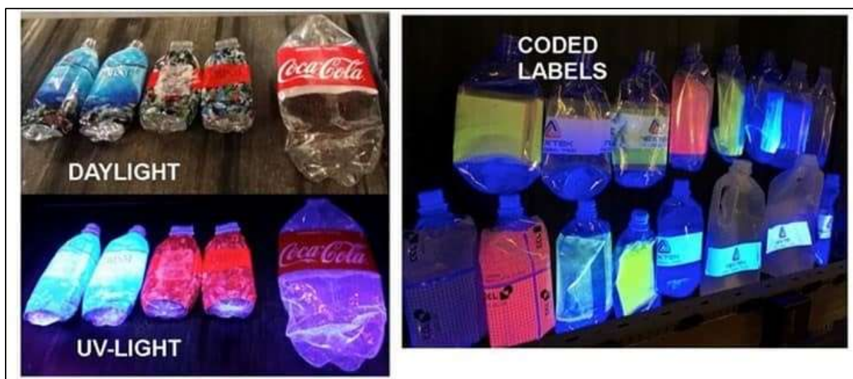
Abbildung 15 Die Markierung von Nextloopp: Oben links sind markierte Objekte (die linken vier Flaschen) und unmarkierte Flaschen (Flasche rechts) im Tageslicht zu sehen; die Markierung ist für das menschliche Auge nicht wahrnehmbar. Im Bild unten links sind die gleichen Objekte unter Anregung von UV-Licht zu sehen, wodurch die markierten Objekte in einer spezifischen Farbe fluoreszieren. Das rechte Bild zeigt die Möglichkeit Markierungssubstanzen mit unterschiedlichen Farbmmissionen (gelb, rot, blau) voneinander zu unterscheiden. Quelle: Recyclingtoday, 2021 24 .
