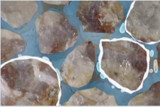
Abbildung 2 CO 2 steigt nach oben (hellblaue Blasen), löst sich auf und reagiert mit Gesteinskörnern, wodurch sich Karbonate auf den Korngrenzen niederschlagen (weiß).
