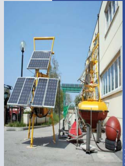
Abbildung 2 Überwachungsboje mit Sonnenkollektoren zur Stromversorgung, Schwimmkörpern und einer Vorrichtung zur Entnahme von Gasproben am Meeresboden.
