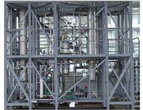
CO 2 -Abscheider im Labormaßstab (im Institut für Energie- und Umwelttechnik), Duisburg
